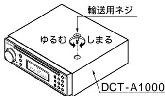
本機の取り付けの前に必ず、本機天面の輸送用ネジを取り外してください。輸送用ネジを外さずに本機を使用すると故障の原因となります。また、外した輸送用ネジは大切に保管し、再輸送をおこなう際には必ず取り付けてください。
